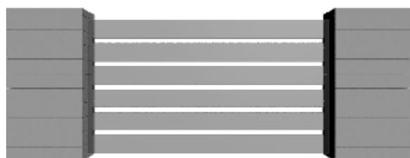
10 блоков+крышка, высота 1512 мм
