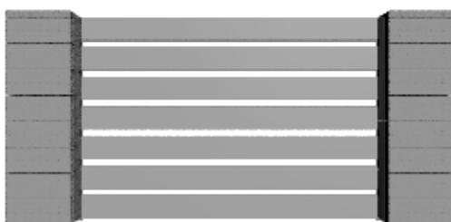
8 блоков+крышка, высота 1650 мм
